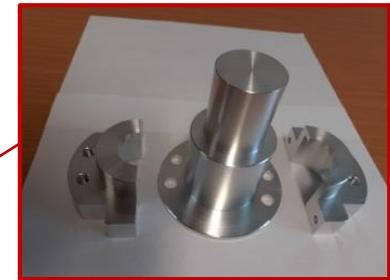
Dispositif permettant d'adapter l'anémomètre ultrasonique haute fréquence au mât de l'UMA.
