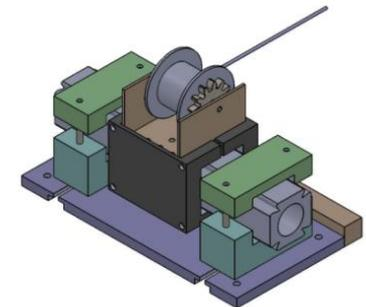
Dispositif permettant de charger / décharger le lidar vent de l'UMA via un treuil
