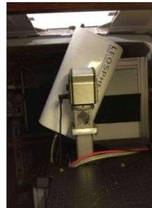
Support permettant de fixer le lidar aérosol à la colonne télescopique de l'UMA
